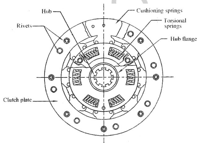
Fig. Clutch Plate
