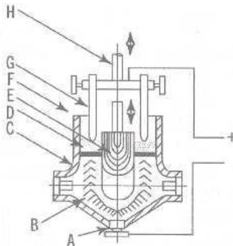
*Fig. 4.13 Electro-slag Casting Process*
