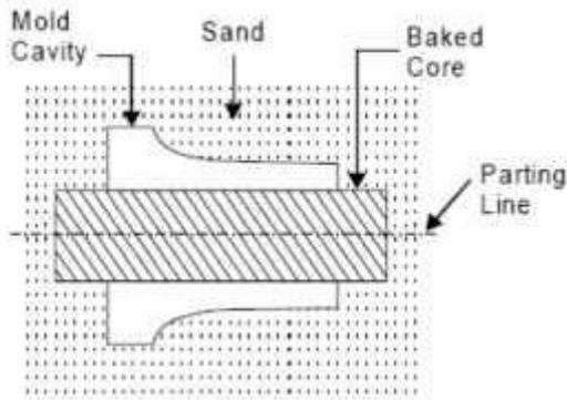
*Fig. 1.28 Horizontal core*
