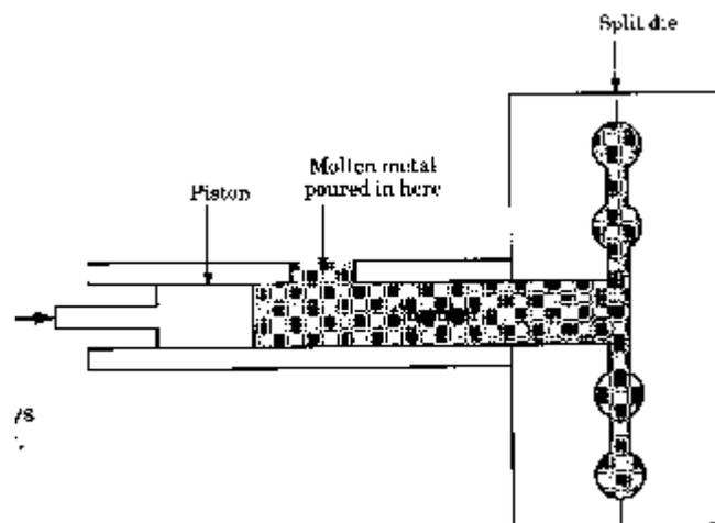
Fig. 4.3 Cold-chamber die casting machine
